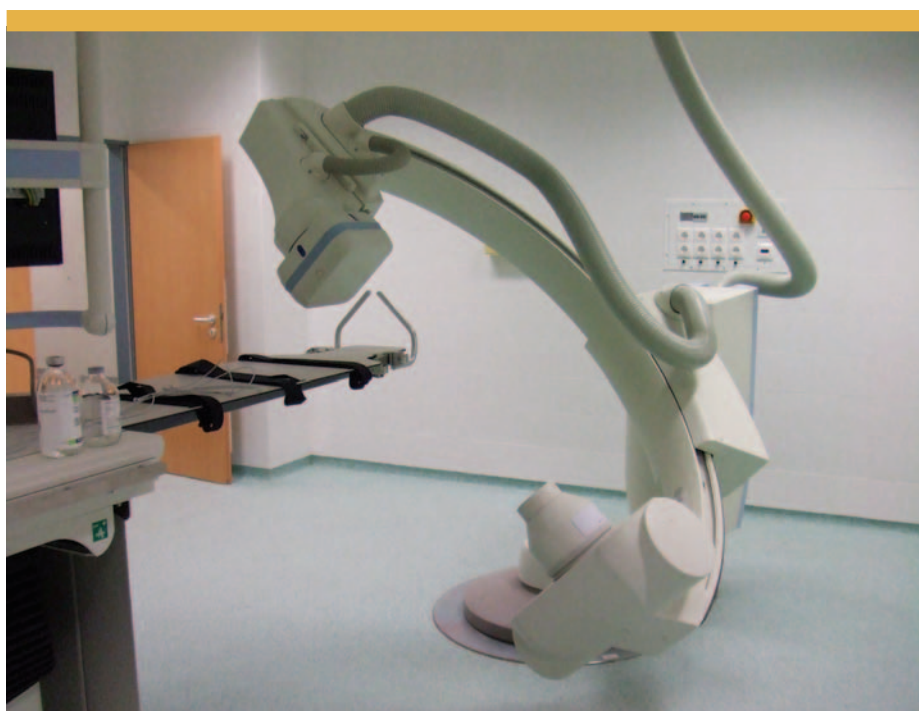
A flat paneles Siemens DSA, még üzembe helyezés előtt
